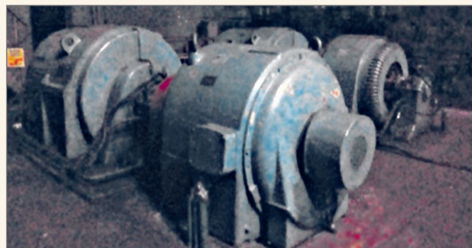
Электромашинные преобразователи №31 и №32 АП прокатного цеха №4.
